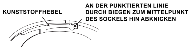
Abbildung 3b: Entfernen des Melders aus dem Meldersockel
