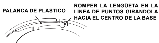
Figura 3b: Quitar la cabeza del sensor de la base
