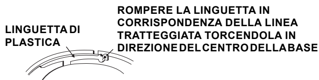
Figura 3b: Rimozione del ripetitore dalla base con la funzione antimanomissione attivata
