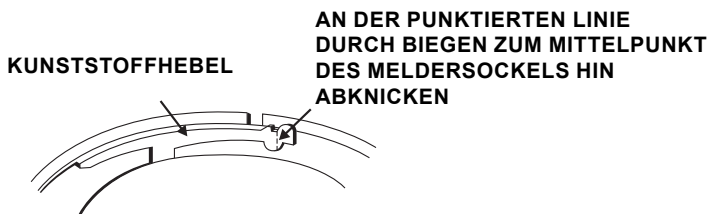
Abbildung 3b: Entfernen des Gateways aus dem Sockel
