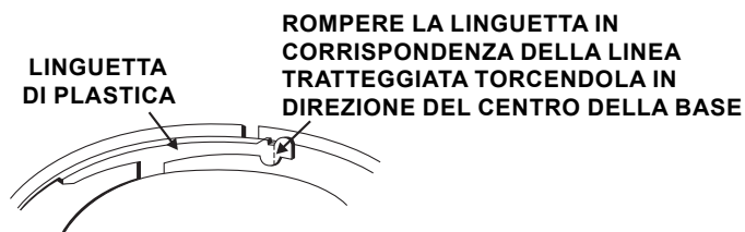
Figura 3b: Rimozione del sensore dalla base con funzione antimanomissione attivata
