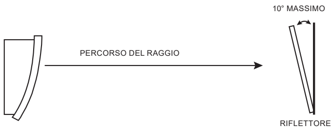
Figura 2b: Montaggio del riflettore, linee guida
