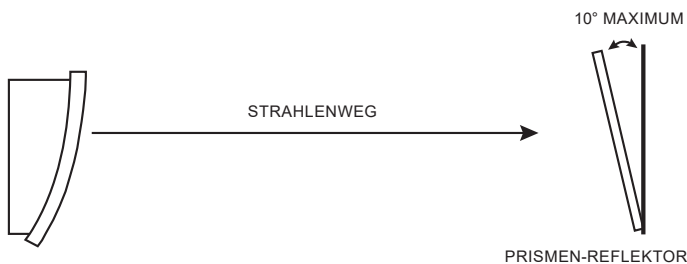
Abbildung 2b: Richtlinien zur Montage des Prismen-Reflektors
