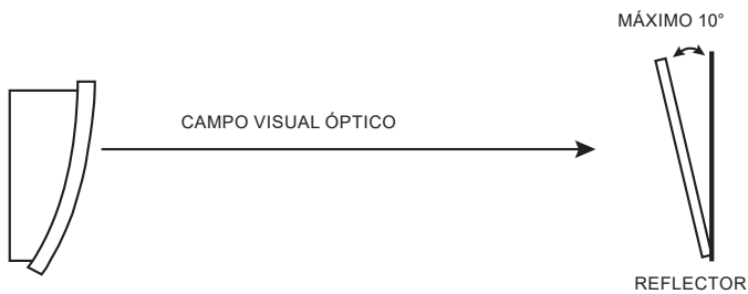
Figura 2b: Instrucciones para el montaje del reflector
