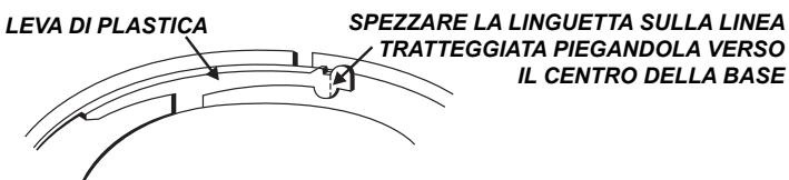
Figura 3b: Rimozione della sirena dalla base
