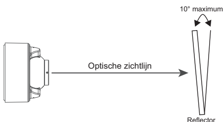
Afbeelding 3-10: Montagerichtlijnen reflector
