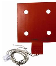
Das BEAMHKR ermöglicht den Betrieb des Reflektors in feuchten Umgebungen, die zur Kondensatbildung führen. Die Kondensatbildung am Reflektor kann zu Fehlern oder falschen Alarmbedingungen führen. Das BEAMHKR verringert die Wahrscheinlichkeit von Kondensation, indem der Reflektor auf einer Temperatur gehalten wird, die etwas höher als die der umgebenden Luft BEAMHKR ist. Das Kit benötigt ein 24 V-Netzgerät.
