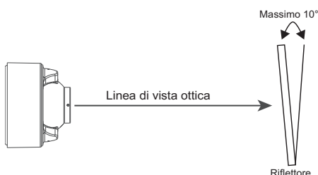
Figura 3-5: Linee guida per il montaggio del riflettore
