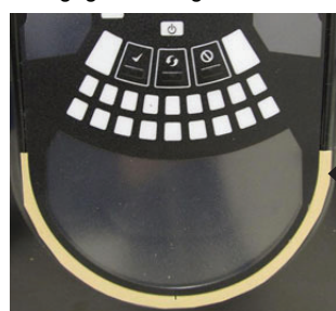
Figuur 3: beschermstrook verwijderen om het venster vast te plakken
