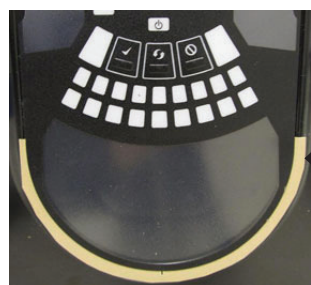
Figura 3: rimozione del rivestimento per incollare la copertura
