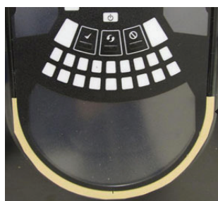
Figure 3: Retirer la pellicule protectrice pour coller le cache
