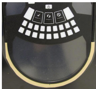
Abbildung 3: Schutz entfernen, um Abdeckung anzukleben
