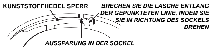
Abbildung 3b: Entfernung des Alarmgebers aus dem Sockel
