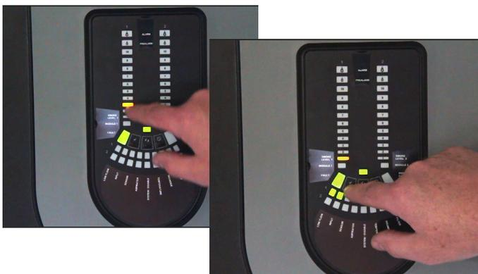
Das blinkende Luftstromsegment wird grün und das nächste Segment beginnt zu blinken, dies zeigt an, dass es bereit ist, die nächste Ziffer einzustellen. Nachdem die vierte Ziffer ausgewählt ist, werden alle vier Segmente des Luftstrompendels ausgeschaltet. Wenn das Passwort akzeptiert wird, springt die Störungs-LED von gelb auf grün um und das Gerät befindet sich im Techniker-/ Wartungsmodus.
