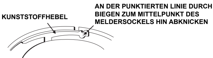
Abbildung 3a: Aktivierung der Entnahmesicherung
