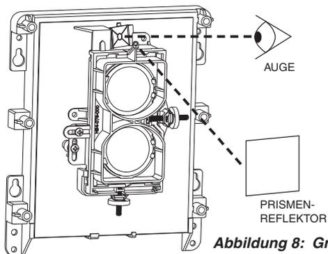
**Abbildung 8: Grobes Ausrichtungsverfahren**
