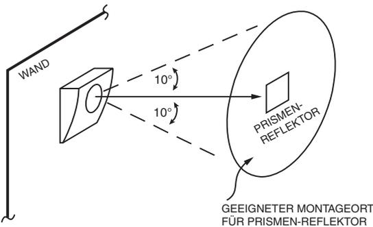
Abbildung 2a: Richtlinien zur Montage des Prismen-Reflektors
