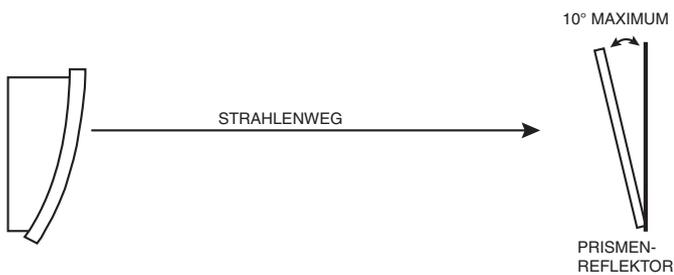
Abbildung 2b: Richtlinien zur Montage des Prismen-Reflektors
