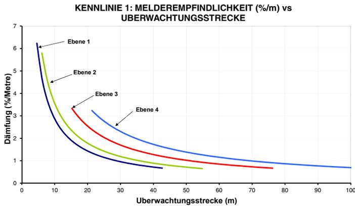
Die automatische Einstellung der Melderempfindlichkeit erfolgt gemäß der Kennlinie 1. Hierbei kann die prozentual angezeigte Dämpfung in die Entfernungsangabe der Messstrecke umgesetzt werden. Für jeden einstellbaren Pegel ist % Dämpfung in eine Entfernungsangabe übertragbar.
