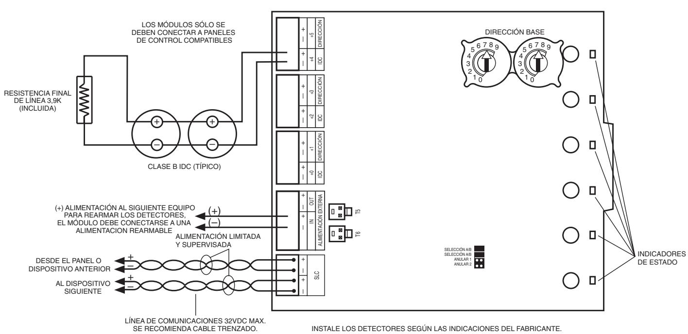
**FIGURA 2: EJEMPLO DE VARIAS TARJETAS CON UNA MISMA FUENTE DE ALIMENTACIÓN EXTERNA Y REARMABLE. LAS CONEXIONES DEL CABLEADO TÍPICO SE MUESTRAN EN LA FIGURA 1. ASEGÚRESE DE QUE LA PESTAÑA DEL PUENTE DE ALIMENTACIÓN ENGANCHAS CON LA PESTAÑA DE SUJECCIÓN EN T5 O T6 COMO SE MUESTRA EN LA VISTA A-A.**
