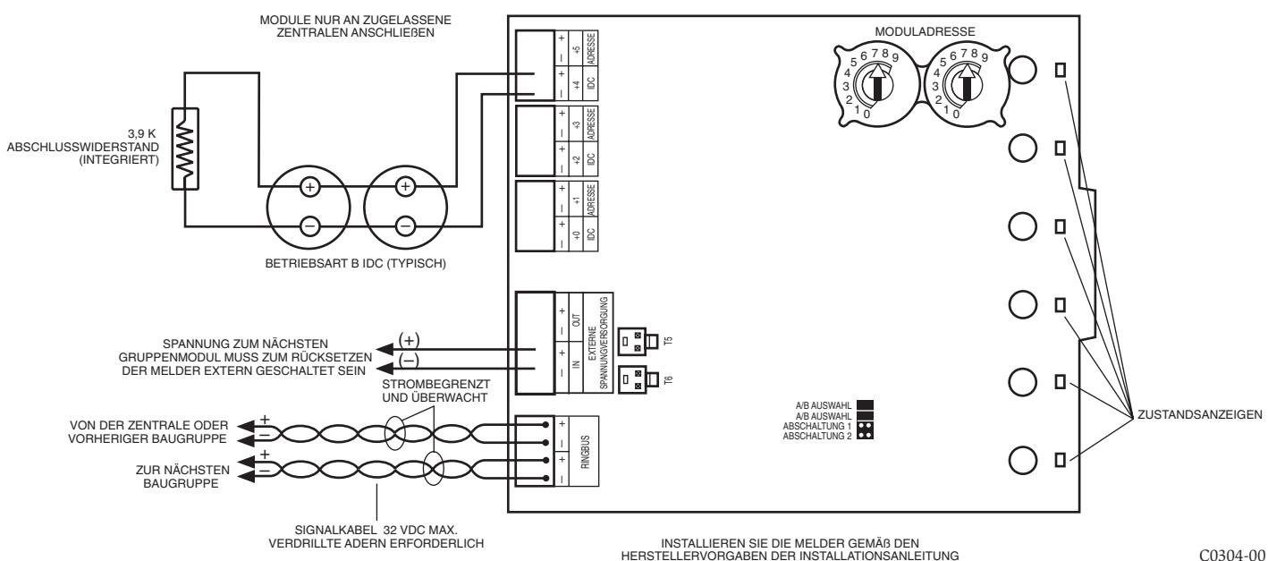
**ABBILDUNG 2: BEISPIEL ZUR GEMEINSAMEN SPANNUNGSVERSORGUNG MEHRERER MODULE. VERGEWISSEN SIE SICH, DASS DER STECKER DES SPANNUNGSKABELS, WIE IN DER DARSTELLUNG A-A GEZEIGT, FEST IN DEN HALTECLIP VON T5 ODER T6 EINRASTET.**
