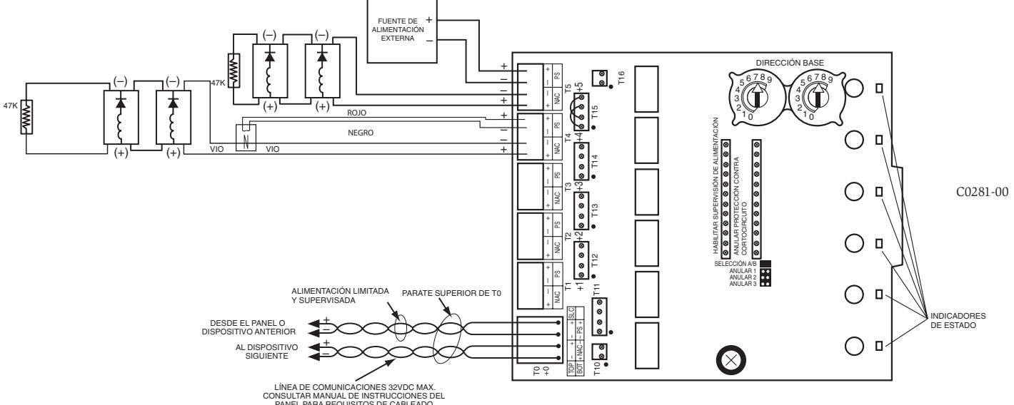
Todo el cableado debe cumplir los códigos de prácticas o normas locales. Cualquier fuente de alimentación externa debe ser de tensión limitada con batería de apoyo.
