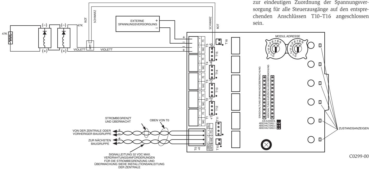
\*Hinweis 1: Die Spule des Abschlussrelais muss zur eindeutigen Zuordnung der Spannungsversorgung für alle Steuerausgänge auf den entsprechenden Anschläßen T10-T16 angeschlossen sein.
