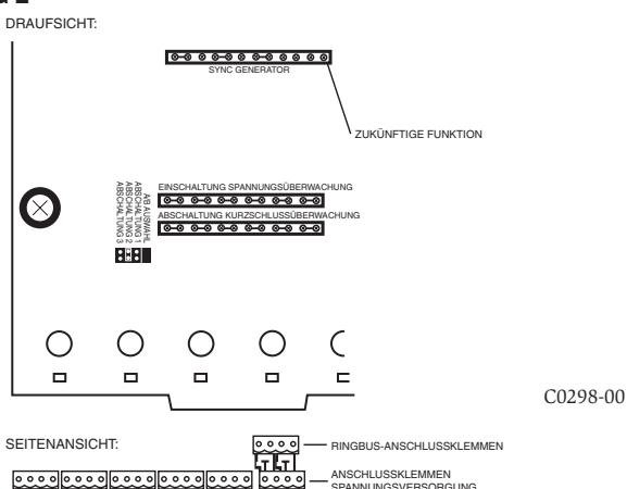
6. Die Überwachung der Spannungsversorgung muss eingeschaltet sein um eine Kurzschlussüberwachung zu ermöglichen. (siehe Abbildung 1). Das Modul wird mit eingeschalteter Spannungsüberwachung ausgeliefert, erkennbar an den sechs großen Steckbrücken auf den Kontakten "Einschaltung der Spannungsüberwachung".
